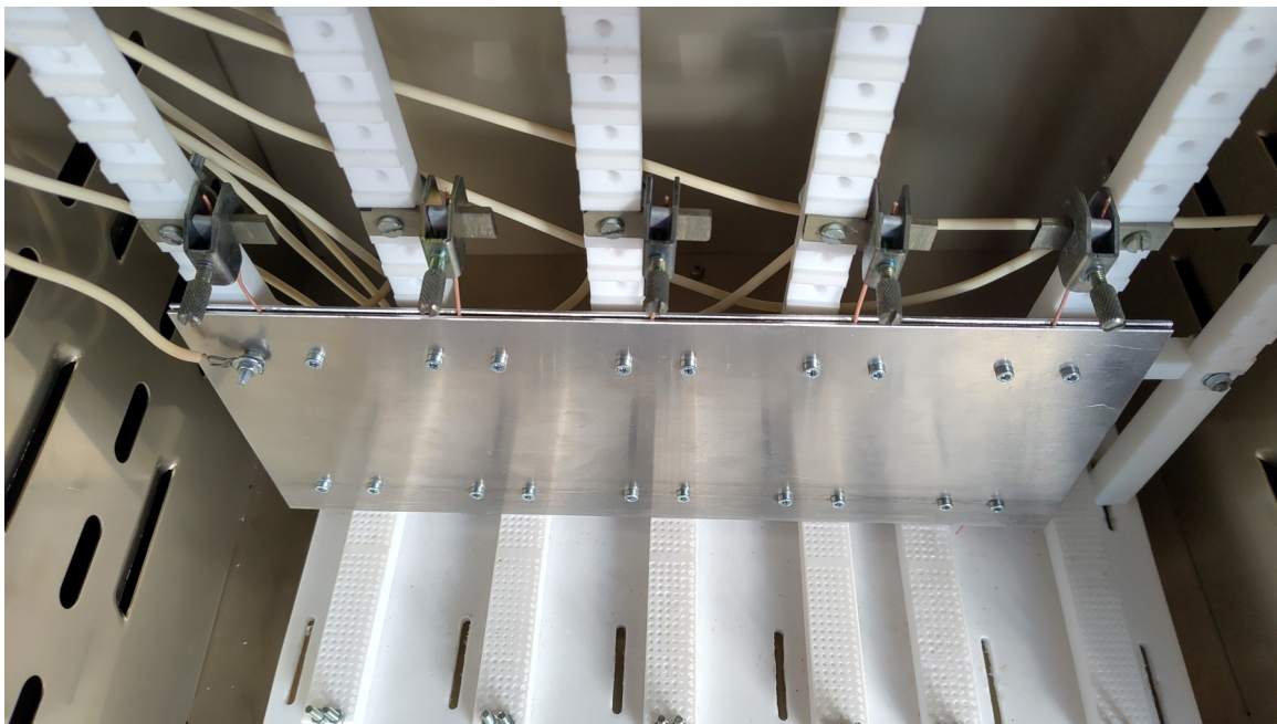
Abbildung 3.5: Plattenanordnung mit eingespannten Prüflingen
