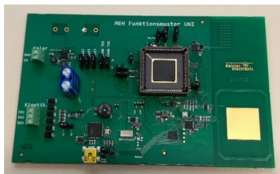
Abbildung 84: Vollintegrierte Funktionsmuster-Platine mit eingesetztem Mikrocontroller-ASIC, Schließsystem-Peripherie und Eingängen für Harvesting-Quellen. Dieses Funktionsmuster wurde durch deister electronic gefertigt.
