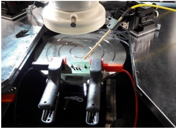
Abbildung 74: Links: Messaufbau für die Verifikation der Startup-Funktion des Spannungswandlers. Rechts: Spannungskurven beim starten des Spannungswandler-ASICs mit verschiedenen Eingangsspannungen V_{in}
