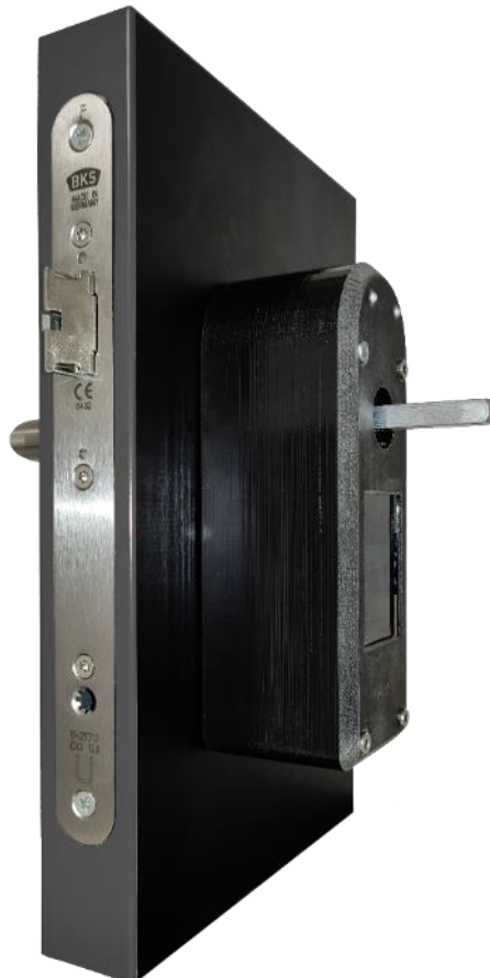
Abbildung 97: Beschlagsschloss Demonstrator mit gehäuseter Elektronik im Gehäuse. Erkennbar ist die Solarzelle auf der Frontseite unter dem Griffbolzen.
