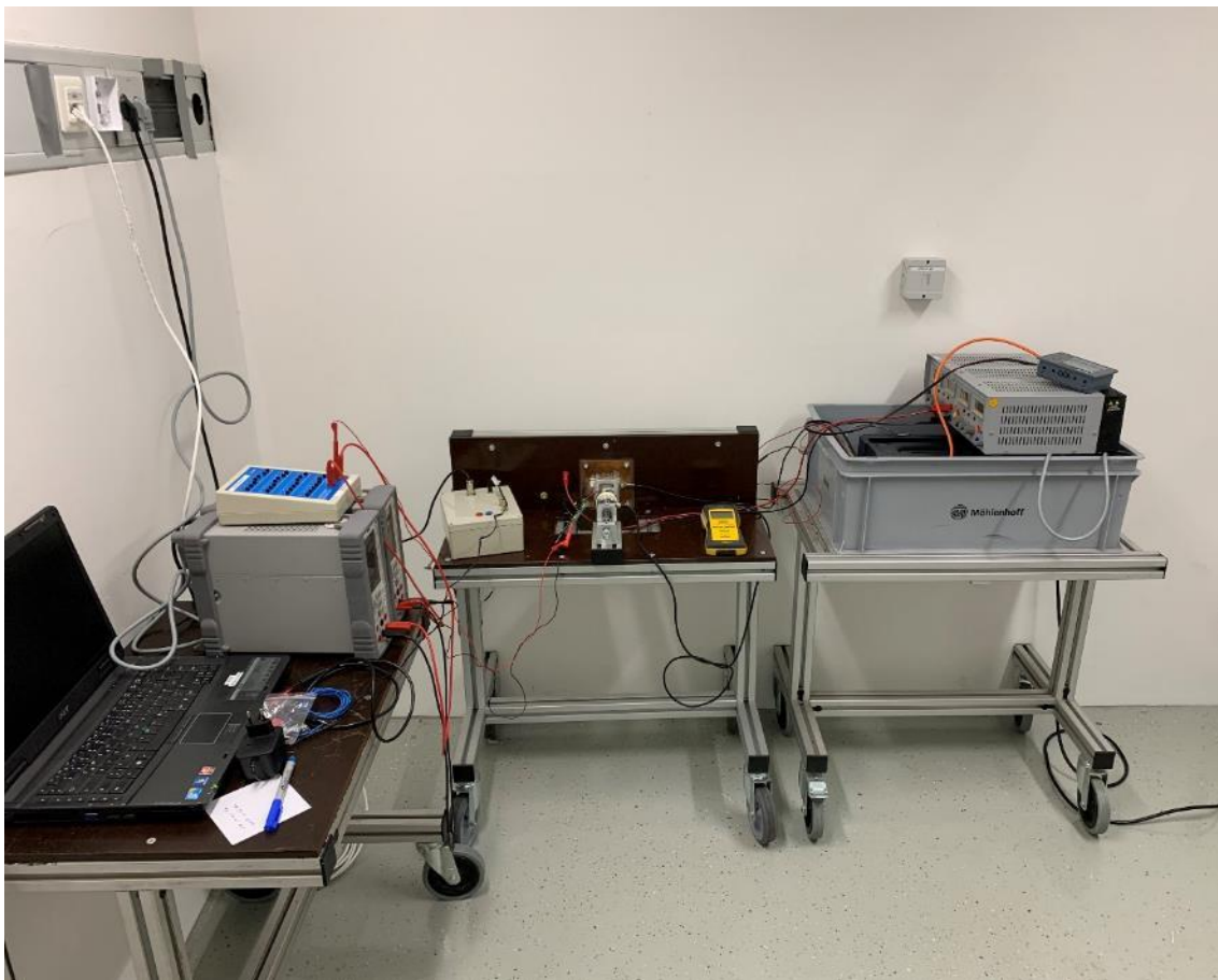
Abbildung 105: Versuchstand zur Untersuchung des Kräfteinflusses und der Leistung des TEG
