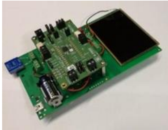
Abbildung 40: Evaluationsboard mit Solarzelle (oben rechts), Powermanagement Aufsatzboard (mitte), und Energiespeicher (links)
