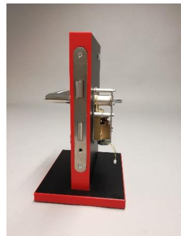
Abbildung 76: Board des Funktionsmusters (links), mechanisches Modell zur kinetischen Energiegewinnung (rechts)
