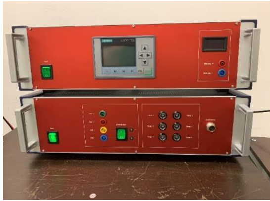
Abbildung 51: Heizungssteuerung und Weitbereichsmessgerät (links), Gesamtaufbau (rechts).
