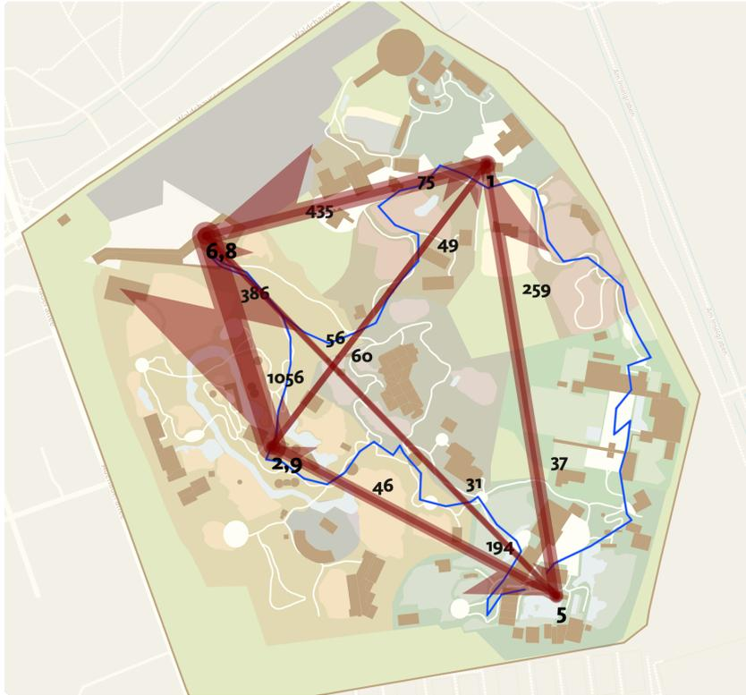
Abbildung 8.6.: Übergangsgraph aller Messungen des 21.08.2022. Knoten bilden Bluetooth-Logger 1 und 5 sowie die Aggregate 6,8 und 2,9. Die Pfeilstärke und Spitzengröße skaliert linear mit dem Kantengewicht. Von 6,8 zu 2,9 wurden mit 1.056 die meisten, von 6,8 zu 5 mit 31 die wenigsten Übergänge erkannt. Weiße Linien zeigen den kurvigen Wegverlauf, die blaue Linie zeigt die jeweils kürzeste Strecke zwischen den Bluetooth-Loggern entlang des Wegs.
