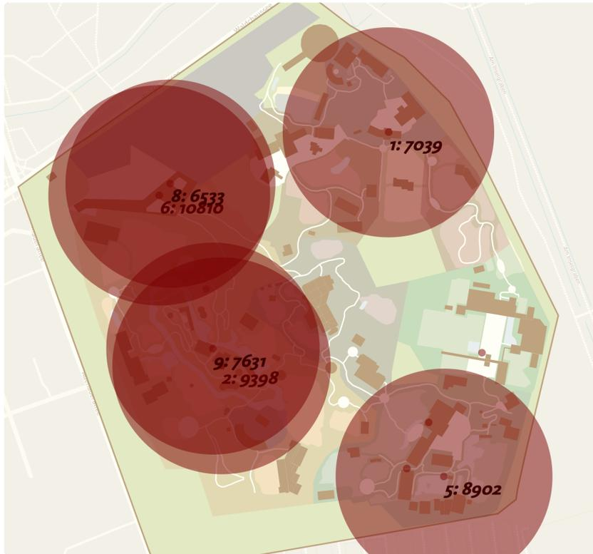
Abbildung 8.4.: Visualisierung der Anzahl Geräte je Bluetooth-Logger aggregiert über den ganzen Tag des 21.08.2022. Die erste Zahl ist jeweils der Identifikator des Bluetooth-Loggers, die zweite die Anzahl gemessener Geräte. Die Kreisradien skalieren mit der Anzahl gemessener Geräte logarithmisch.
